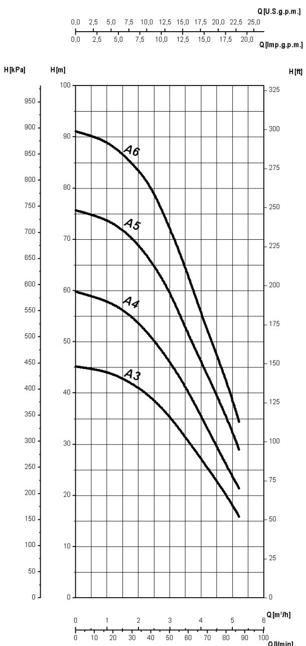
• CARATTERISTICHE IDRAULICHE • HYDRAULIC FEATURES • CARACTERISTICAS HIDRAULICAS • CARACTÉRISTIQUES HYDRAULIQUES
